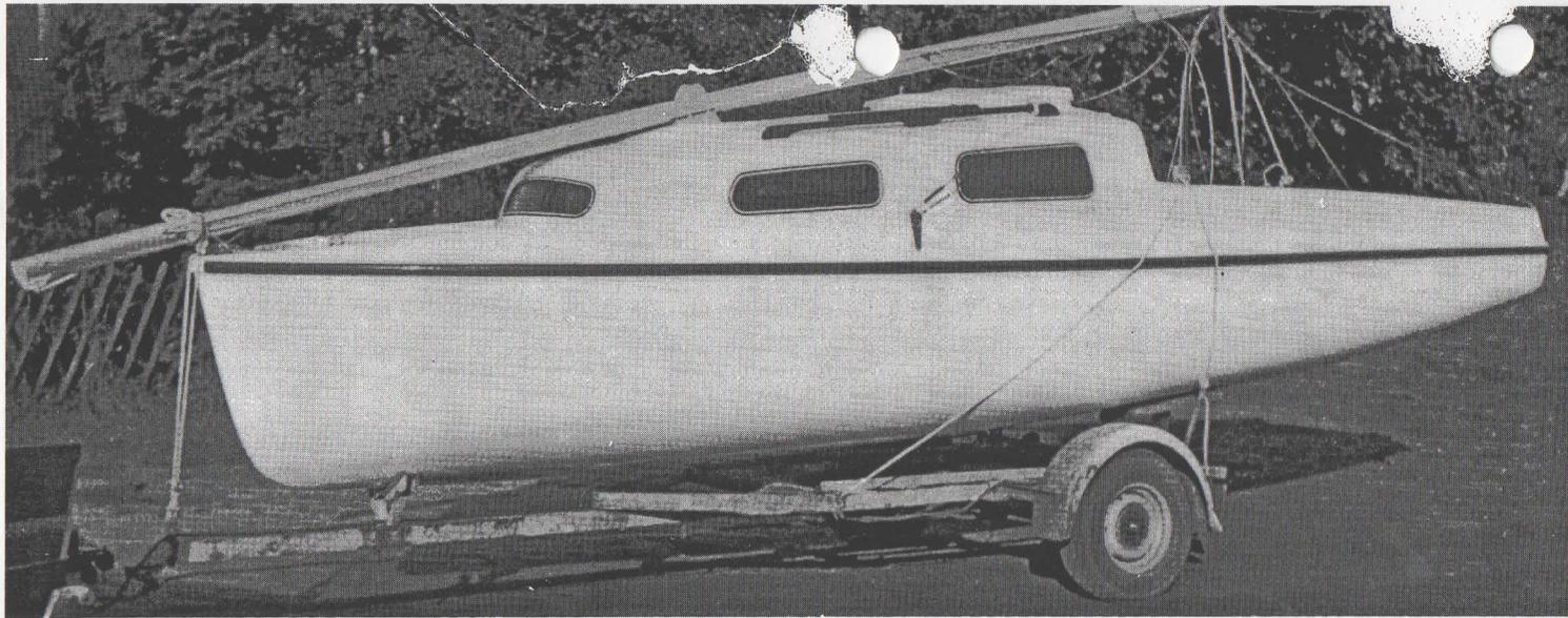
Der NEPTUN-P-Jollenkreuzer auf dem Transportanhänger. Mit ca. 600 kg Transportgewicht sollte man unbedingt einen Anhänger mit Auflaufbremse wählen. Der Transport hinter fast allen deutschen Mittelklassewagen ist so zulässig, z. B. VW 1500.
